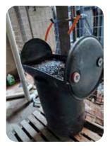
é o uso de uma estação artesanal de limpeza de pincéis e latas de tinta, utilizada para remover resíduos de tintas e solventes. O equipamento é composto por um tambor cortado com divisórias e preenchido com materiais filtrantes, como por exemplo brita ou cascalho, que ajudam a reter partículas sólidas da tinta. Geralmente, a estação de limpeza funciona com um sistema de circulação de água, onde os resíduos mais pesados se depositam no fundo e os filtrantes impedem que partículas contaminantes
