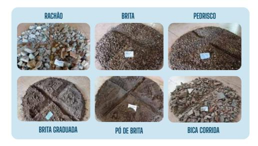
Atualmente em Campo Grande, a produção e comercialização dos agregados reciclados são do tipo misto, conhecido como ARM - Agregado Reciclado Misto. Esse material é gerado a partir da britagem conjunta de materiais cimentícios (concreto, argamassas, blocos, pré-moldados de concreto, etc), materiais cerâmicos (blocos, telhas de cerâmicas vermelhas, azulejos, etc), e solo (terraplanagem).
